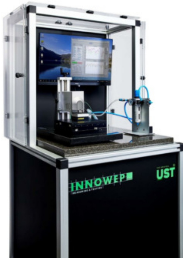
Bild 11 – Universal Surface Tester UST® zur taktilen Untersuchung der Oberflächentopografie und lokalen Deformationseigenschaften (QUELLE: Innowep GmbH)
